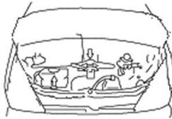
1. La gata se coloca debajo de la tapa frontal del vehículo (la tapa frontal abre, ver la descripción “interruptor de la tapa frontal” en el artículo 7 de sección 3. Apriete el eje de balancín de la gata en sentido antihorario, se puede quitar la gata. Cuando coloque el gato, Apriete el eje de balancín de la gata en el sentido de las agujas del reloj y asegúrese de que está fijado y estable.
