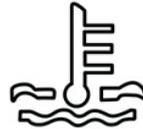
Cuando la temperatura del agua es superior a 105 °C, esta luz parpadea, indicando que la temperatura del agua es alta; es necesario comprobar si falta agua tan pronto como sea posible. Si supera los 110 °C, esta luz se iluminará y el vehículo debe ser estacionado al lado del camino para su revisión.
