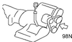
Cuando la correa del motor está demasiado floja, afecta la presión de electricidad y ello causa que la correa esté demasiado caliente y con más desgaste. Cuando realice la inspección, presione la correa con la presión adecuada; debe aparecer una depresión de 6-8 mm.
