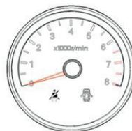
El tacómetro se muestra en r/min y representa la velocidad del motor. La escala mínima es 500r / min.
