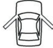
Esa luz indicadora se usa para mostrar el estado de cada puerta del vehículo; si cualquier puerta no está cerrada, las luces se encenderán, advirtiendo al conductor que alguna puerta no está cerrada; cuando la puerta está cerrada, la luz se apaga.
