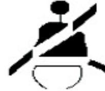
Cuando el interruptor de encendido está conectado, este indicador se ilumina de inmediato. Si se inserta la hebilla del cinturón en el encaje, la luz se apaga, indicando así que el cinturón de seguridad está abrochado.
