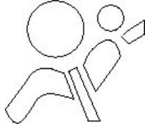
Esa luz indicadora muestra el estado de funcionamiento del airbag cuando el interruptor de encendido está en la posición "ON"; mientras el interruptor de encendido está conectado, el vehículo empieza a realizar una autocomprobación, tras lo cual las luces se apagan automáticamente después de unos segundos. Si se mantienen iluminadas, indica que el airbag tiene una avería.
